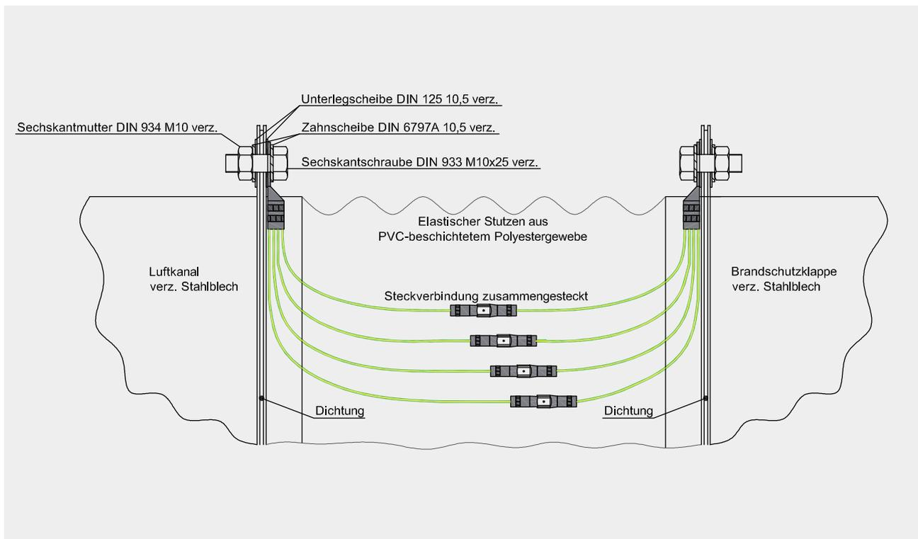
**Bei kleineren Luftkanalquerschnitten ist die Verbindung ebenfalls möglich:** mit Sechskantschrauben (M8x25 nach DIN 933), Sechskantmuttern (M8 nach DIN 934), Unterlegscheiben (DIN 125, 8,5 verzinkt) und Zahnscheiben (DIN 6797, 8,5 verzinkt).
